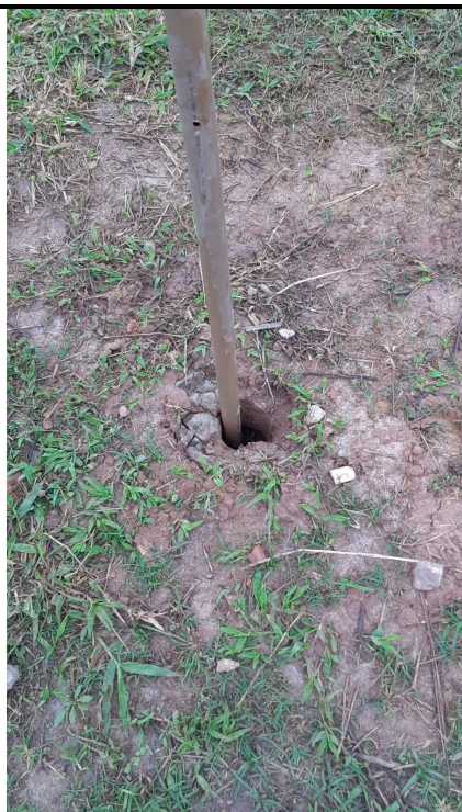
Foto 19 - INA (Indicador de NA instalado no SP16)
